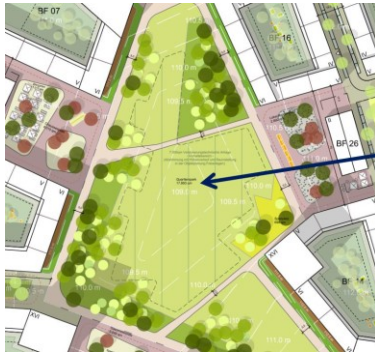
Abbildung 8 I. Grünfläche des geplanten Quartiers L 416 welches mit Wasser eingestaut werden kann; r. Darstellung eines Tiefbeets zur Versickerung im Rahmen von BlueGreenStreets; Quellen: Stadt Leipzig 2021, bgmr Landschaftsarchitekten 2021
