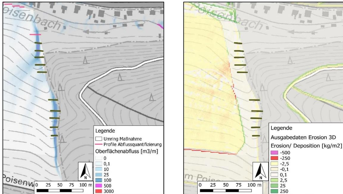
**Abbildung 24: Graphische Darstellung der Ausgabedaten für den Oberflächenabfluss (links) und die Erosion/Deposition (rechts) der Ergänzungsvariante (Begrünte Überlaufschwellen)**
