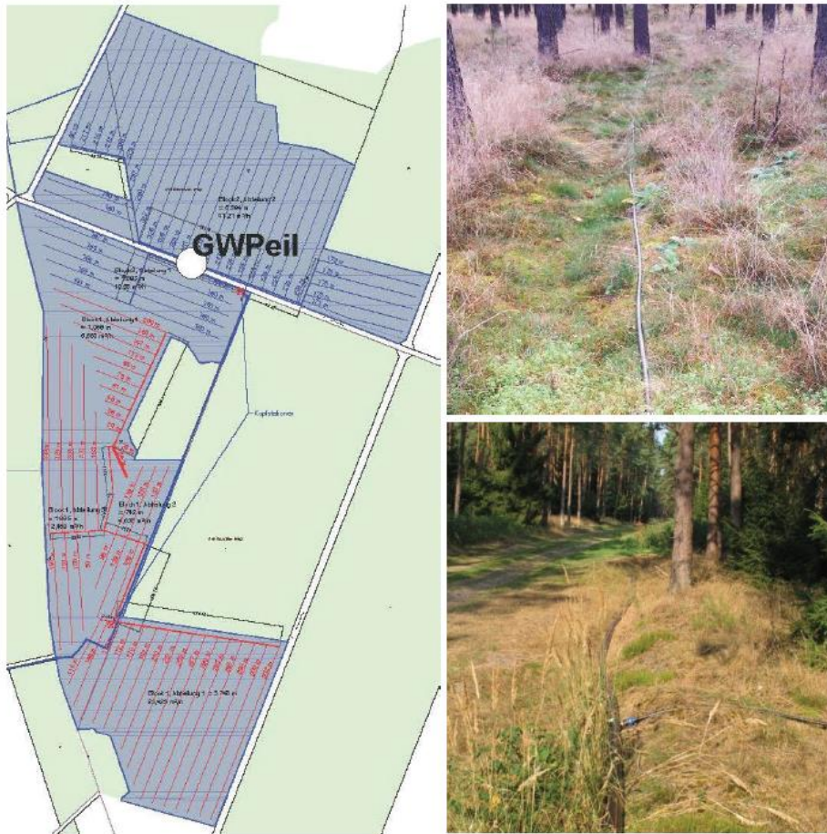
Abbildung 47: Aufbau (links) und Beispielansichten (rechts) der Versickerungsanlage. Quelle: Schulz 2014
